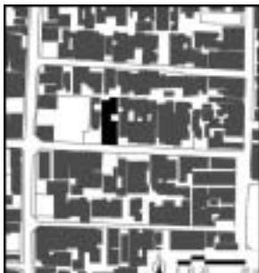
図6：ケース ケース4は、街区内部の凹凸のある形状を引用し、北側の形状を決定している。また、ソリッド内部に存在するヴォイドがランダムに配置されているのを引用し、隣棟とはヴォイドの位置をずらしている。
