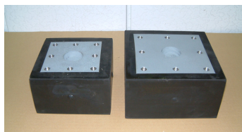
写真-1 HDR 供試体
